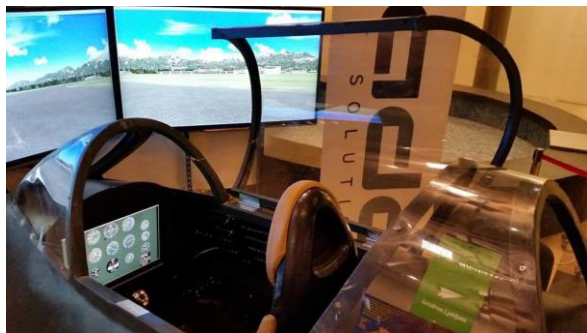
Slika 3. Trenažer za uvežbavanje letenja i navigacijskih procedura FNPT Nivo II namenjen prvenstveno vojnom vazduhoplovstvu
